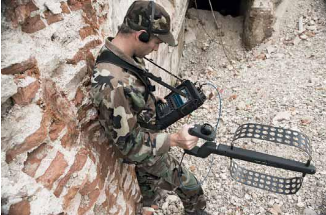
Рис. 1-6. Отслеживание сигналов радиоэлектронных устройств с помощью R&S®PR100 и R&S®HE300.
