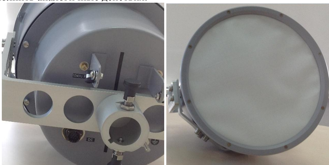
Рисунок 4 – Расположение входа внешнего источника опорного сигнала (слева), фронтальная крышка влагозащитного корпуса (справа), вариант 2.
