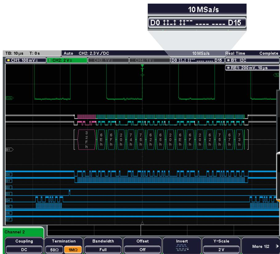
Экран активности: информация о состоянии цифровых сигналов вне зависимости от настроек захвата и настроек прибора
