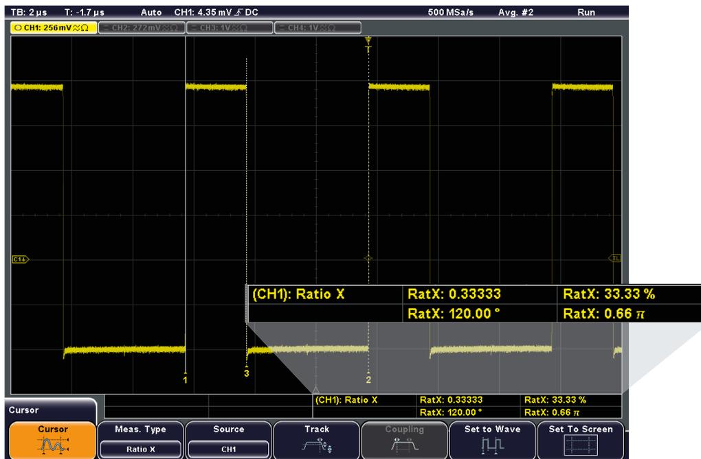
Курсор для определения коэффициента заполнения импульсного сигнала
