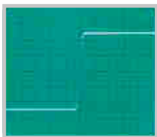
Отсутствие искажений сигнала (выбросов)
