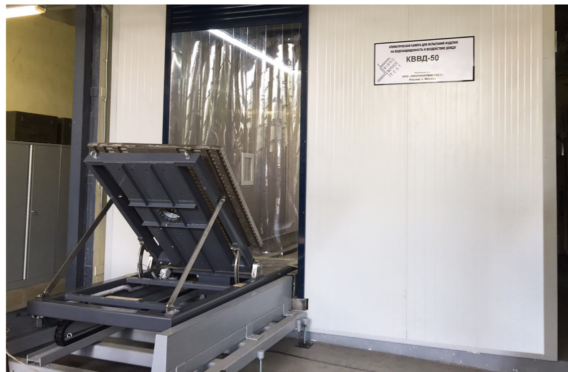
Климатическая камера КВВД-50 укомплектована системой водоподготовки
