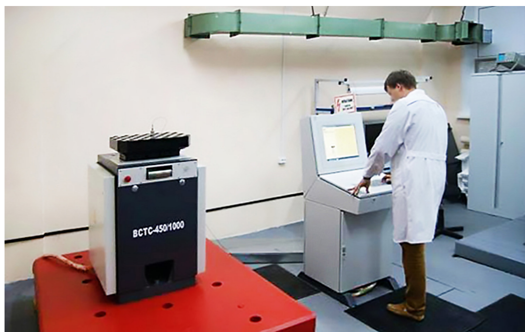
Антивибрационная платформа, на которой установлена Ударная установка ВСТС-450/1000
