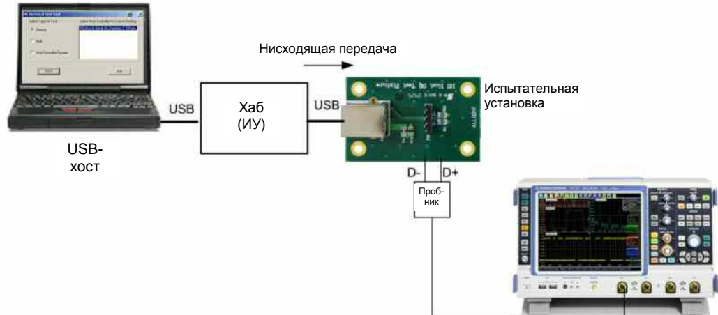
Рисунок 27 – Схема измерения для тестирования качества сигналов хоста в режиме HS на нисходящем порте хаба
