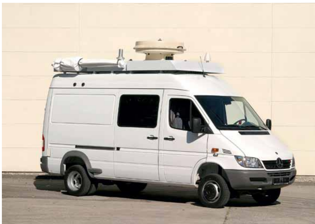
Рис. 5-1. Мобильный комплекс радиомониторинга и пеленгования. Антенна R&S®ADD295
