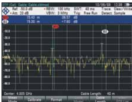
Измерение расстояния до места повреждения (DTF)
