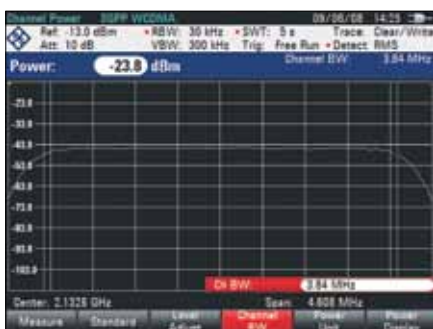
Измерение мощности в канале
