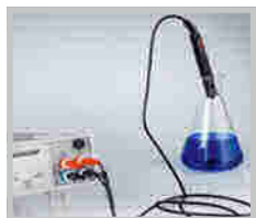
Измерение температуры датчиком HZ887 в составе прибора НМ8112-3
