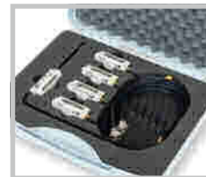
Набор пробников ближнего поля HZ550L (3 ГГц)
