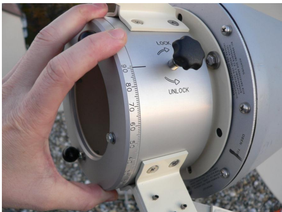
Рис 2. Устройство механического изменения поляризации (не входит в комплект стандартной поставки)
