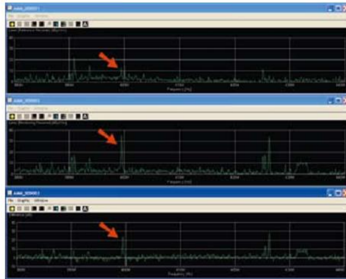
Рис. 1-6. Отображение различий в уровнях сигналов посредством дифференциального спектра
